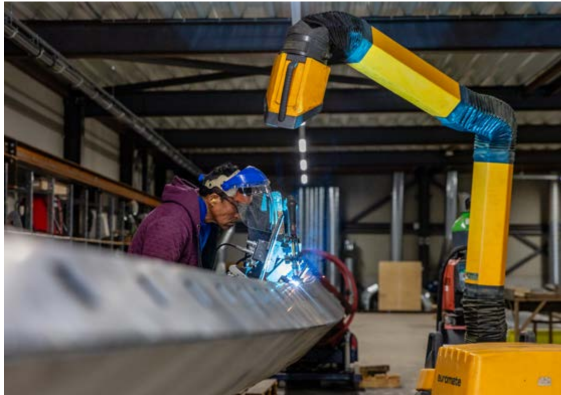
bewerkingsmachine nieuwe molenwieken uit staalplaten en boort er de klinknagelgaten in. Ook het laswerk gebeurt in eigen huis.
